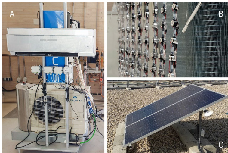
Figura 1. Prototipo utilizado como banco de pruebas. Sistema de refrigeración solar con pre-enfriamiento evaporativo del aire de entrada al condensador.
