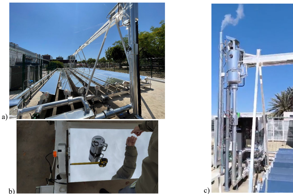
Figura 2. Instalación experimental a visitar: a) colector Fresnel, b) medidor de reflectividad portátil, c) separador de vapor y línea de extracción de vapor
