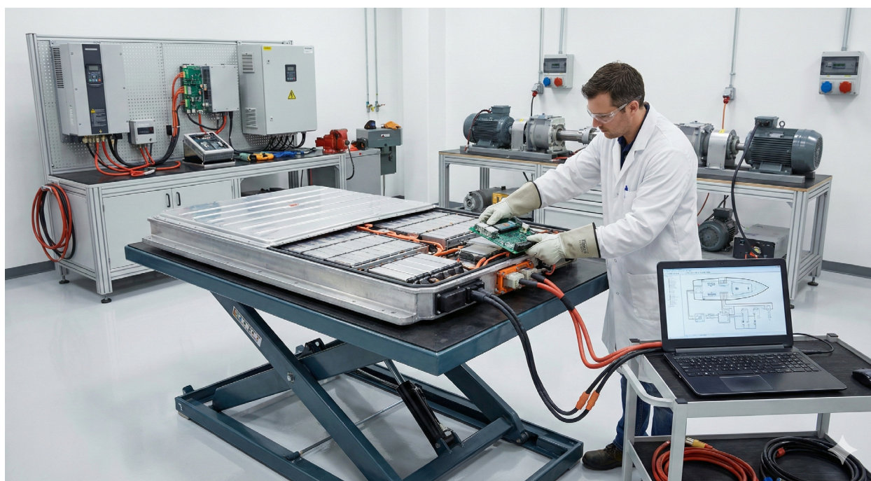
Fig 2. Proceso de adaptación de electrónica en batería de VE sin desmontaje de módulos.
